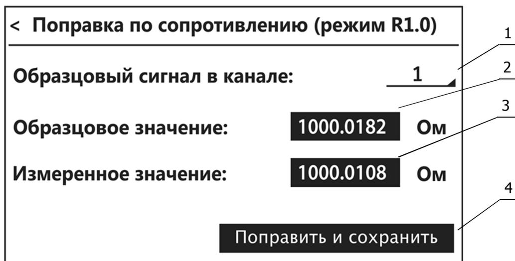
Рисунок 5 — Окно поправки опорного сопротивления
