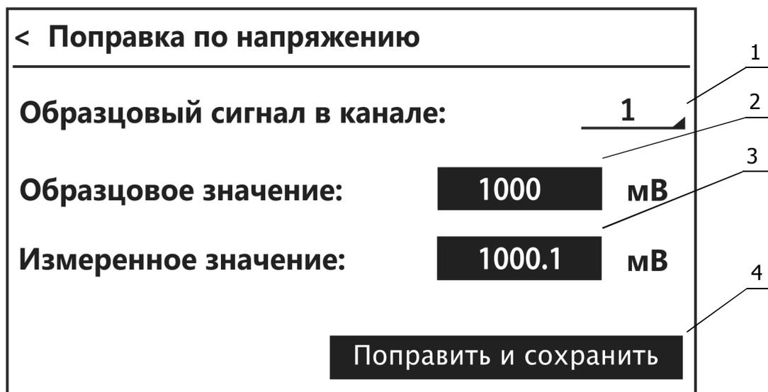
Рисунок 4 — Окно поправки опорного напряжения
